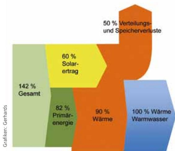
*Konventionelle Wärmeerzeugung; die Zusatzheizung zur Solarthermie wird durch Verbrennung z. B. von Gas mit dem Primärenergiefaktor 1,1 erreicht. Die Verteilverluste im Haus sind mit ca. 33 % sehr hoch.*
